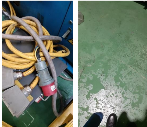
Gambar 4.10 Housekeeping Kabel Terkelupas dan Ceceran Air
