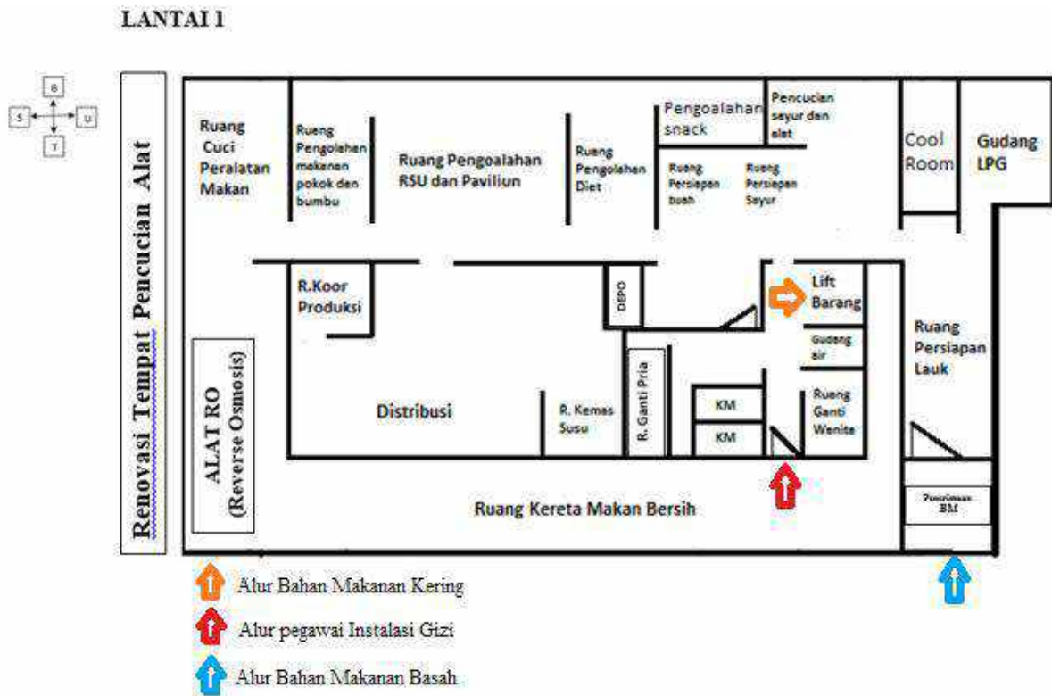
Gambar 4.4. Layout Instalasi Gizi lantai 1
