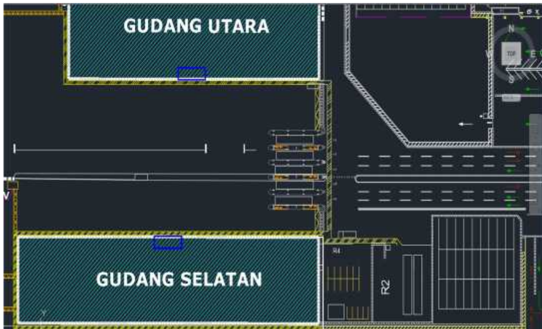
Gambar 4.16 Usulan desain Jalur Pedestrian di Depan Gate Terminal Jamrud
