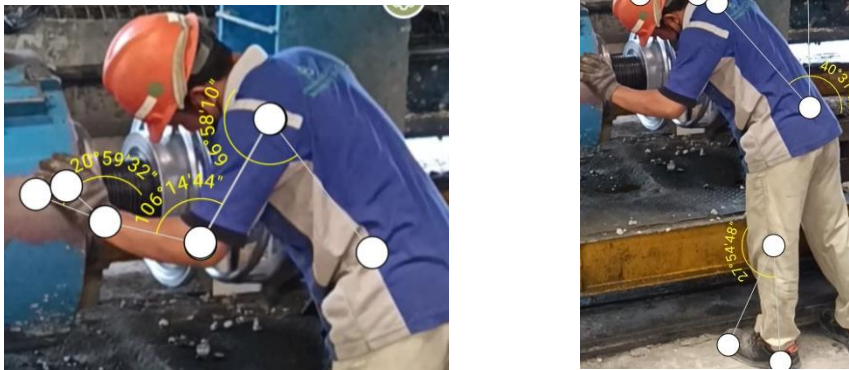
Gambar 4.2 Posisi Kerja Pekerja Bagian Spinning
