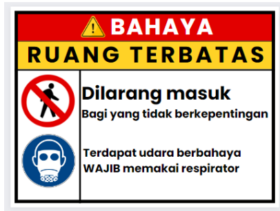
Membuat safety sign confined space
