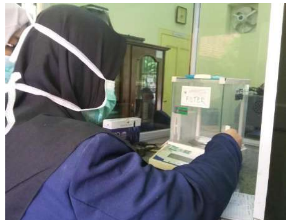
Gambar 6.10 Penimbangan PM yang Melekat pada Filter
