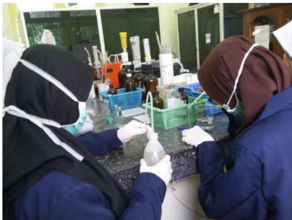
Gambar 6.9 Persiapan Sampel Udara Uji \text{NH}_3
