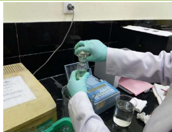
Gambar 6.12 Pengujian TSS pada Air Limbah
