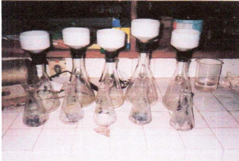
**Gambar 7. Alat untuk Analisis Serat Kasar**
