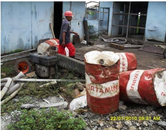
Gambar 7. Bahan bakar solar (saran sebaiknya di tempatkan secara rapid an terhindar dari panas).
