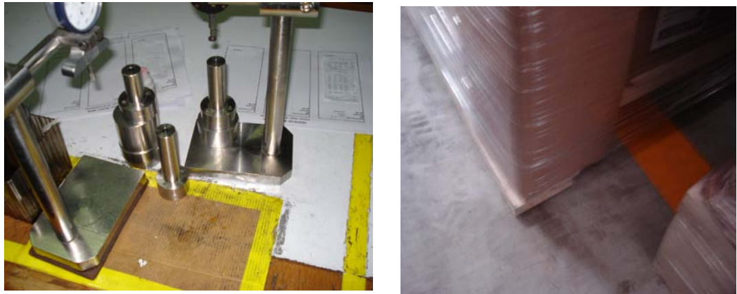
Gambar 4.9 Peletakan barang yang melebihi tanda batas
