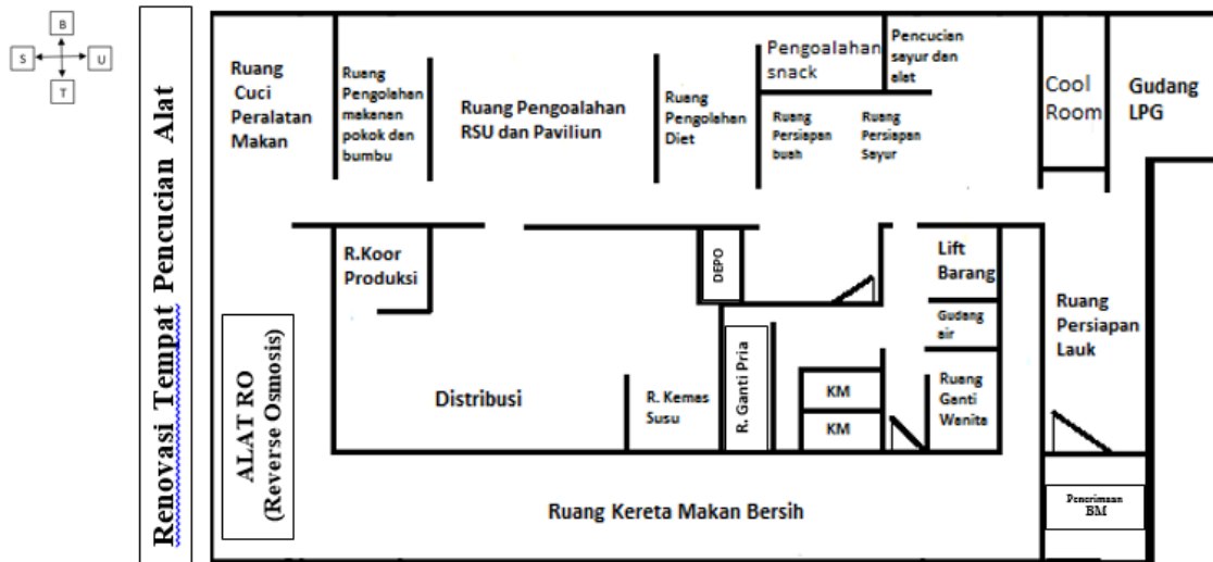
Gambar 4.4. Layout Instalasi Gizi lantai 1
