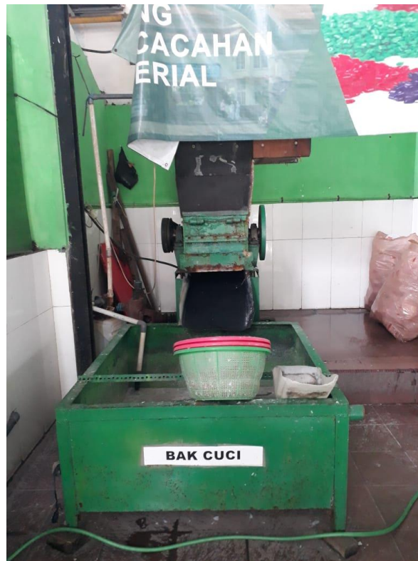
Gambar 4.16 Mesin Pencacah Botol Infus Bekas dan Jerigen Bekas Hemodialisis Untuk Didaur Ulang.
