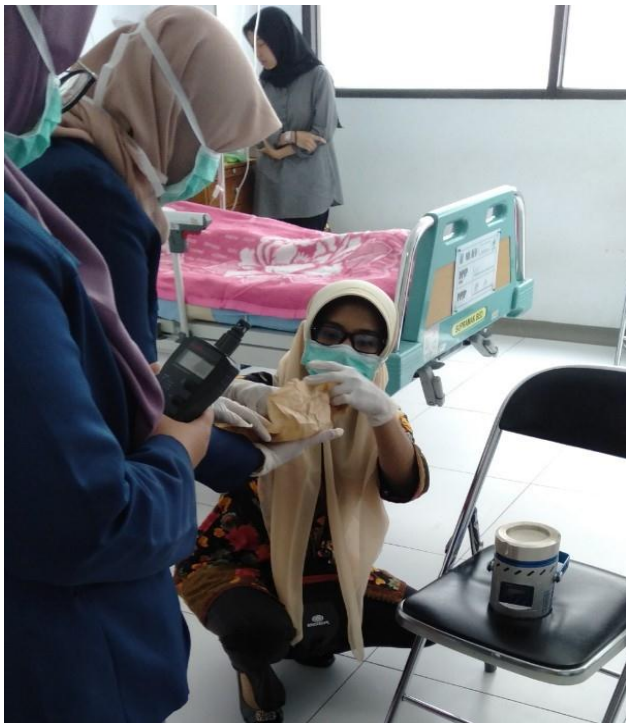
Pengukuran Suhu dan Kelembapan serta Angka Kuman pada Kamar Pasien di Gedung PPJT
