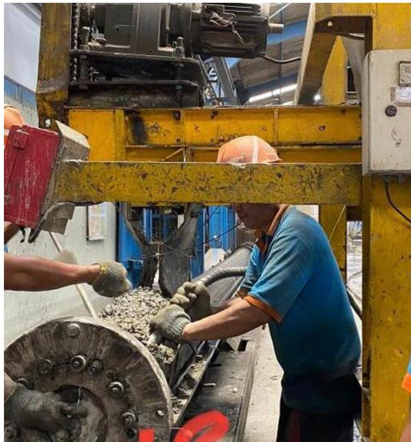
**Gambar 3. Pekerja Menggunakan Internal Vibrator**
