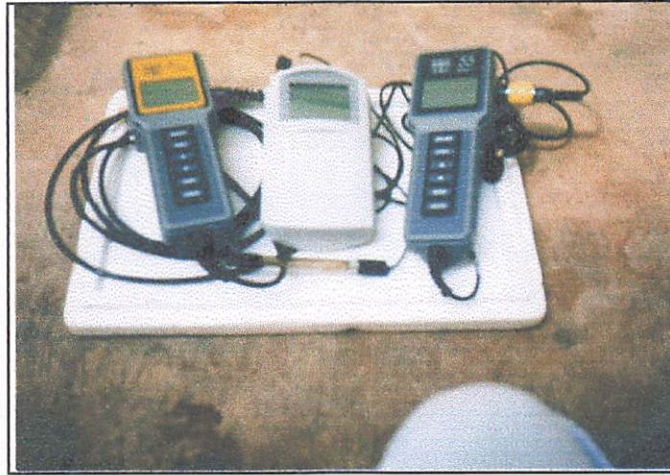
Gambar 11. Salinometer, pH meter dan DOmeter.
