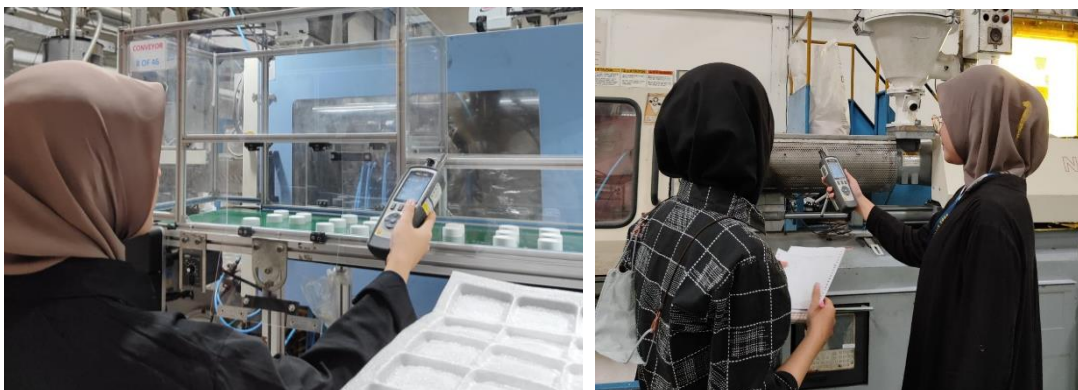
Gambar 5. 5 Pengukuran Kadar Debu pada Unit Produksi Menggunakan Particle Counter
