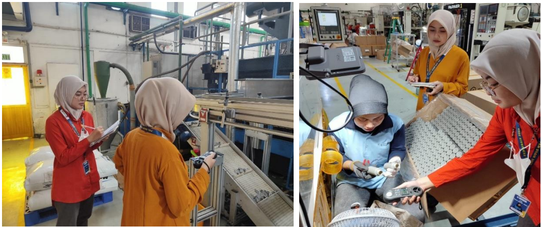
Gambar 5. 3 Pengukuran Intensitas Pencahayaan pada Unit Produksi Menggunakan Lux Meter
