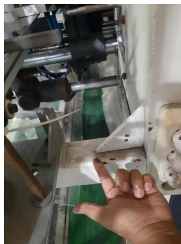
Gambar 4.27 Kondisi body mesin yang berdebu
