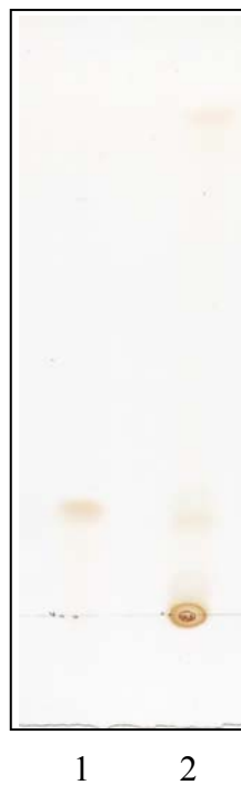
Gambar 5.6 Hasil uji KLT dengan fase diam silika gel dan fase gerak kloroform : aseton : asam formiat (9:1:1)
