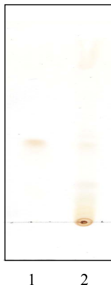
Gambar 5.1 Hasil uji KLT dengan fase diam silika gel dan fase gerak kloroform : aseton : asam formiat (150:33:25)
