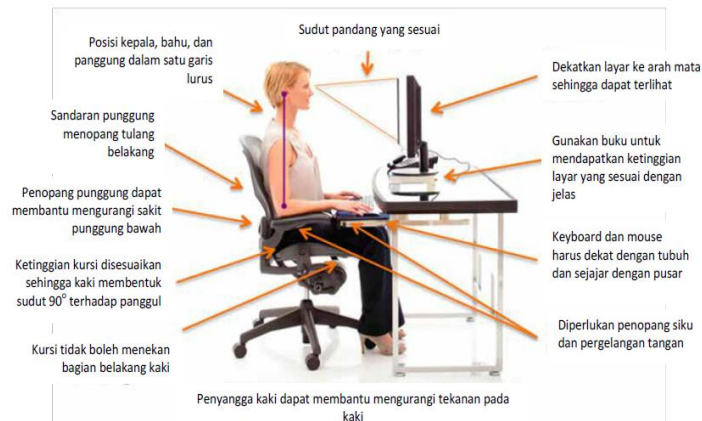
Gambar 2.1 Posisi Bekerja dengan Komputer yang Ergonomik (Sumber : Permenkes No. 48 tahun 2016)
