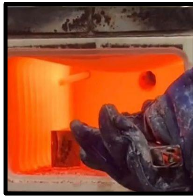
Gambar 3. 7 Proses Burn Out dalam Mesin Preheating Furnace
