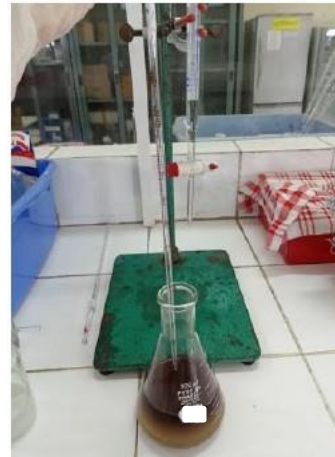
Penitrasian Menggunakan \text{K}_2\text{Cr}_2\text{O}_7
