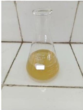
Penambahan \text{H}_2\text{SO}_4 dan KI ke dalam larutan sampel garam
