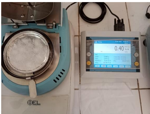
Pengecekan Hasil Uji Kadar Air Sampel Garam
