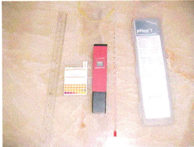
Gambar peralatan untuk mengukur kualitas air (pH paper, pH pen dan termometer)
