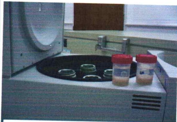
Sentrifuse digunakan untuk mempercepat pemisahan antara matriks tulang dan mineralnya
