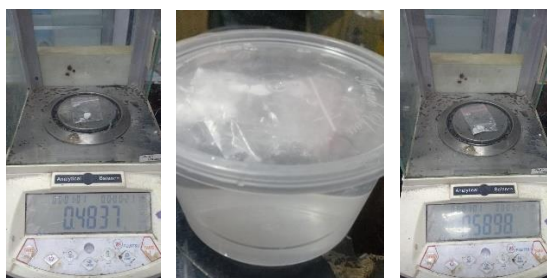
Sampel ditimbang massa kering
