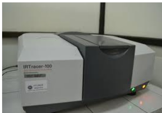
Gambar 3.2 Alat Uji FTIR Shimadzu IRTracer-100 (Lab. Kimia, Universitas Airlangga).
