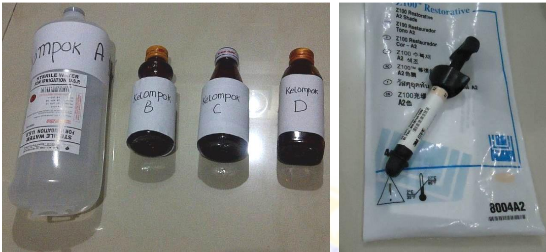
Gambar 4.2 Bahan yang digunakan dalam penelitian: Minuman energi A pH 3,2; minuman energi B pH 3,7; minuman energi C pH 3,9; aquadest pH 7; resin komposit hybrid .
