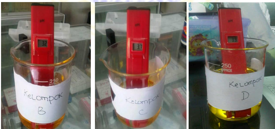
Gambar 4.3 Pengukuran pH minuman energi menggunakan pH meter
