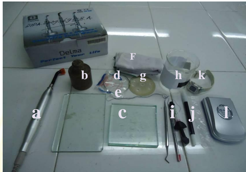
Gambar 4.1 Alat yang digunakan dalam penelitian; a. LED light curing unit, b. anak timbangan 1 kg, c. glass lab , d. kawat, e. benang, f. lap bersih, g. cetakan, h.glass beker, i. plastic filling , j. spidol, k. stopwatch , l. timbangan
