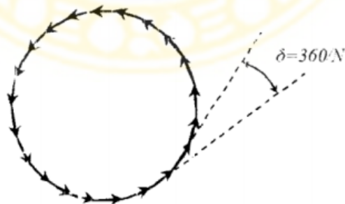
Gambar 2.15. Diagram fasor untuk menghitung minimum pertama dalam pola difraksi celah tunggal (Tipler, 2001).
