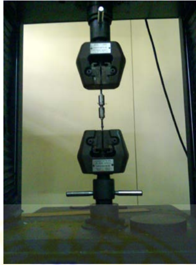
Gambar 2.6 alat uji kuat rekat Autograph Shimadzu
