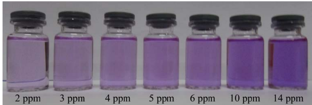
Gambar 4.8 Deret intensitas warna kompleks (RB)_2-Zn(CNS)_4 dengan variasi konsentrasi rhodamin B dalam bentuk larutan
