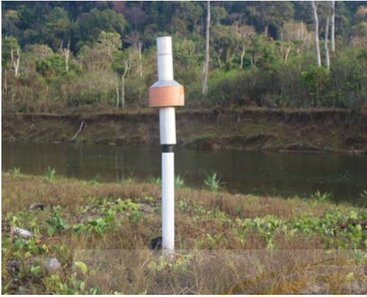
Alat Ukur Curah Hujan (Ombrometer) dan Pengukuran Suhu sarang
