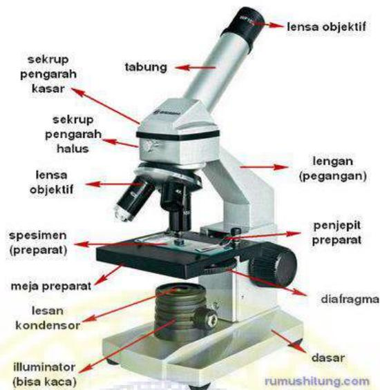
Gambar 2.8 Bagian - Bagian Mikroskop
