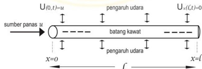
Gambar 4.1 Konduksi Panas pada Batang Kawat
