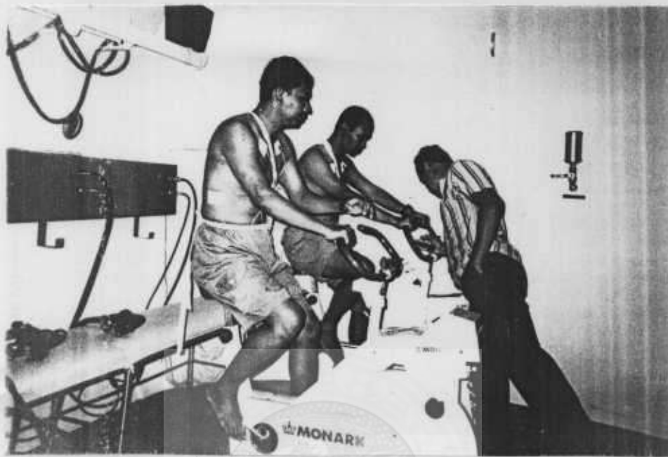
Pembebanan submaksimal yang dilakukan di dalam RUBT (LAKESLA), dengan menggunakan sepeda ergometer.
