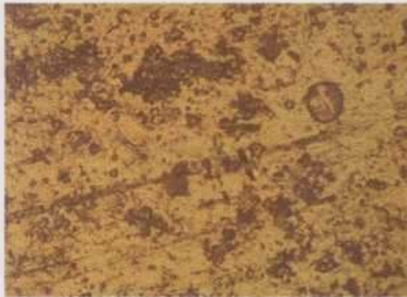
Gambar 5.4 Struktur permukaan plat resin akrilik setelah direndam dalam akuades selama 60 hari ( Mikroskop cahaya pembesaran 500 X )
