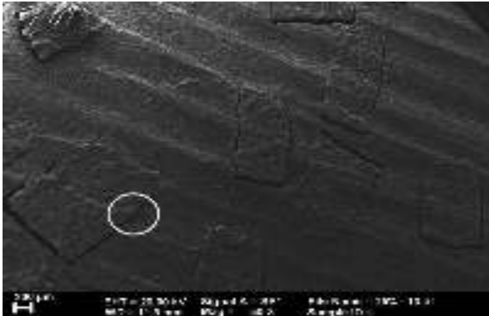
Gambar 4.6 Hasil Uji SEM Permukaan pada Fraksi Volume Serat 25% dengan Perbesaran 50 kali
