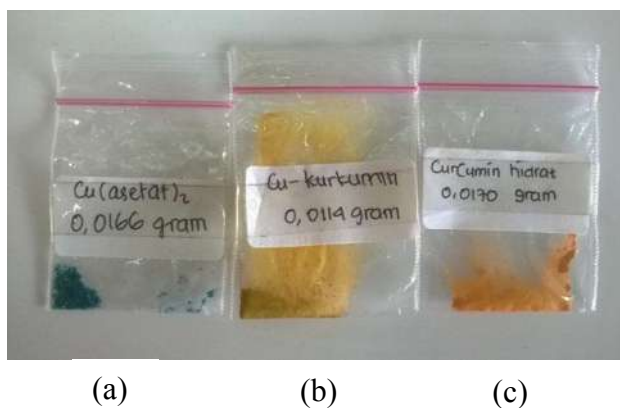
Gambar 4.1 (a) logam Cu(II) dari tembaga(II) asetat hidrat, (b) senyawa kompleks Cu(II)-kurkumin hidrat, dan (c) ligan kurkumin hidrat
