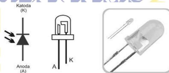
Gambar 2.9 Simbol dan bentuk fisik untuk photodiode
