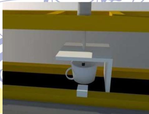
Gambar4.3 Sikat yang terhubung dengan pneumatic *cylinder*
