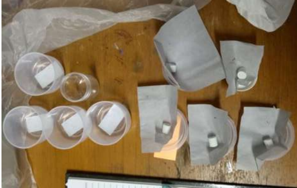
Proses uji porositas saat sampel dikeringkan
