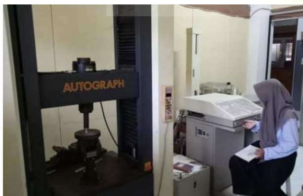
Proses uji kuat tekan
