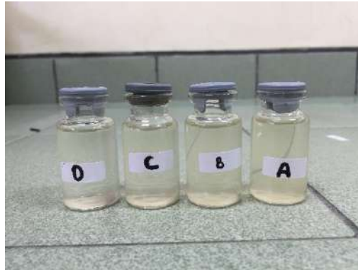
Gambar 3.3 Sampel dengan Variasi Komposisi Kolagen-Kitosan dengan Penambahan Plasticizer Gliserol : (a) 6:4:2 ; (b) 7:3:2 ; (c) 8:2:2 ; (d) 9:1:2 (Dokumentasi Pribadi).
