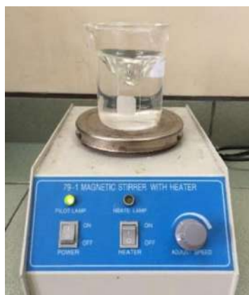
Gambar 3.1 Proses pembuatan larutan kolagen dengan stirrer (Dokumentasi Pribadi).
