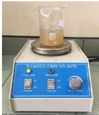
Gambar 3.2 Proses pembuatan larutan kitosan dengan stirrer (Dokumentasi Pribadi).
