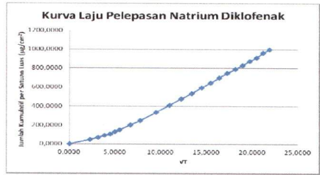
Gambar 1. Kurva hubungan antara jumlah natrium diklofenak ( \mu\text{g}/\text{cm}^2 ) pada mikroemulsi dalam basis gel yang terlepas vs akar waktu ( \sqrt{\text{menit}} ) (data merupakan rerata 3 kali replikasi)
