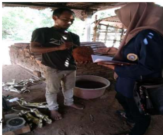
Gambar 2.30. Proses membungkus pola dengan tanah liat/ Mbungkus
