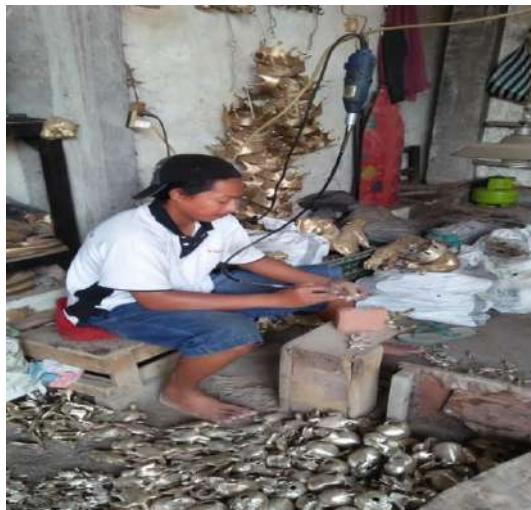
Gambar 2.34. Proses perbaikan kerajinan cor kuningan melalui cara manual
