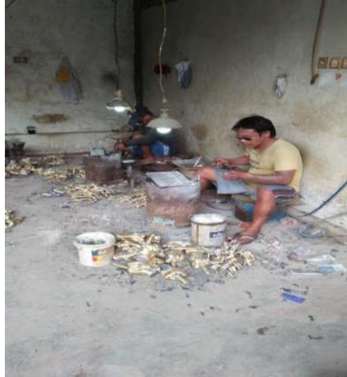
Gambar 2.35. Proses perbaikan kerajinan cor kuningan dengan cara las
