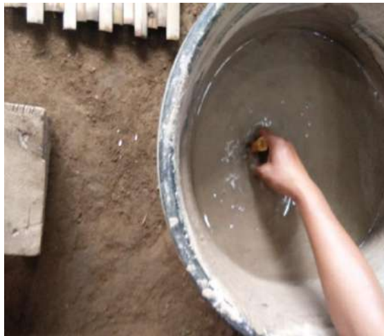
Gambar 2.29. Proses pencelupan pola/ Mill
